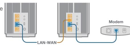
3 El sistema AiMesh detectará automáticamente la mejor trayectoria para la transmisión de datos, ya sea cableada o inalámbrica.
